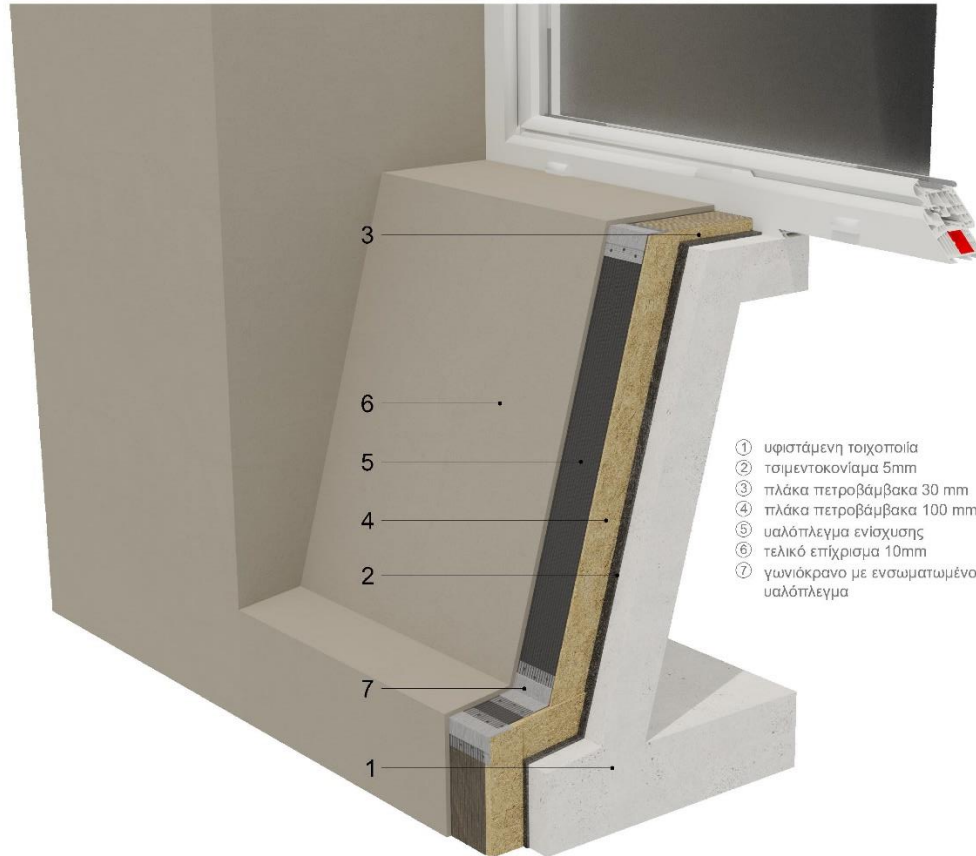
Εικόνα 27: Κατασκευαστική λεπτομέρεια θερμοπρόψης στην ποδιά του παραθύρου
